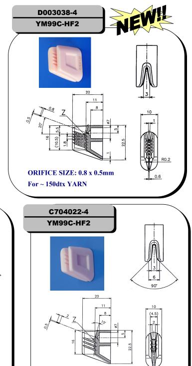
ORIFICE SIZE: 2.0 x 0.5mm For 150 ~ 1000dtx YARN
